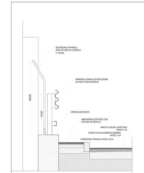
DETTAGLIO 1 : SEZIONE BARRIERA DI PROTEZIONE - RAPP. 1/20
